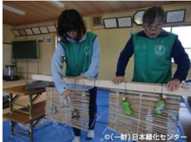
割竹を桁の前縁に置いて編み込む
