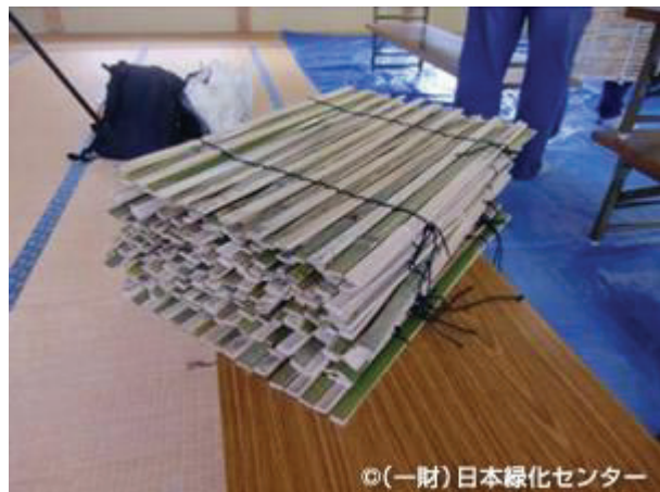
完成した竹簧（端が揃っている側を天にして、 下側20cmを地中に埋め込む）
