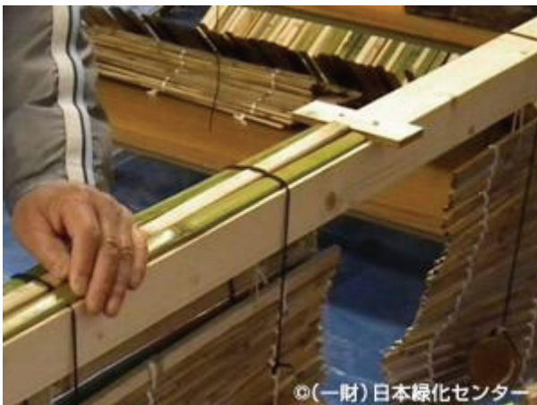
左側の定木に竹の端を合わせ仕上がり揃える
