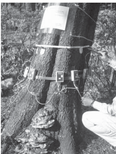
写真5 ピカス診断機器での調査 幹に取り付けたすべてのプローブを順次ハンマーで叩く
