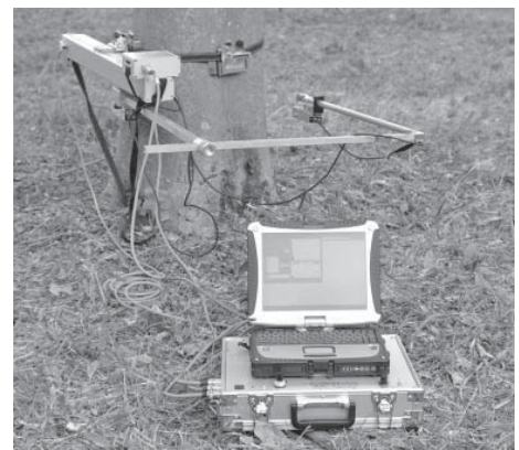
写真4 \gamma 線樹木腐朽診断器 直径約1.3m程度まで測定できる。写真は吊り下げタイプで直径約0.6mまで対応。
